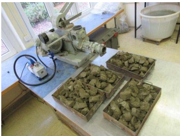
Slika 3: Laboratorijsko oblikovanje in žganje gline z dodatki odpadkov/sedimenta za oceno ustreznosti odpadkov glede njihove uporabnosti v opekarski industriji. Avtor: interno gradivo ZAG.
