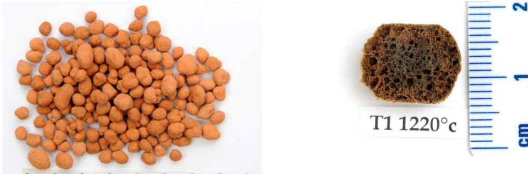
Slika 4: Primer laboratorijsko pridobljenih lahki agregat na osnovi gline in prerez izbranega vzorca. Avtor: interno gradivo ZAG .
