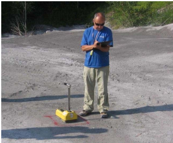
Slika 2. Testno polje (zgoraj levo), s kontrolnimi meritvami doseženih deformacijskih lastnosti (zgoraj desno) in zgoščenosti (spodaj levo), ter izvedbo sondažnega izkopa z odvzemanjem vzorca (spodaj desno) v izvedbi Zavoda za gradbeništvo Slovenije. Avtor: interno gradivo ZAG.
