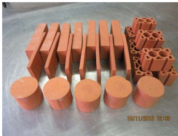
Slika 3: Laboratorijsko oblikovanje in žganje gline z dodatki odpadkov/sedimenta za oceno ustreznosti odpadkov glede njihove uporabnosti v opekarski industriji. Avtor: interno gradivo ZAG.
